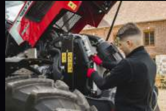
Охладителният модул е леснодостъпен за по-бързо и лесно почистване.
