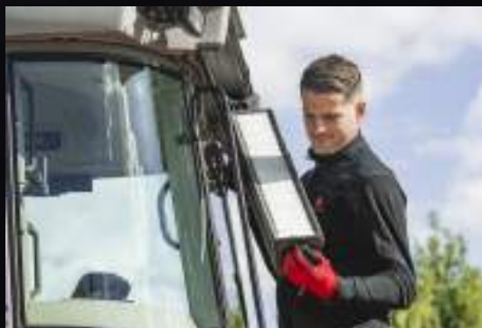
Лесен достъп за сваляне на въздушния филтър на кабината за почистване.
