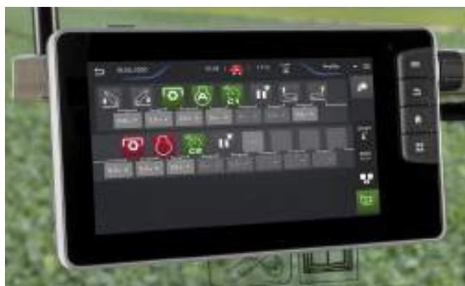
УПРАВЛЕНИЕ НА КРАЯ НА ПОЛОСАТА е налично чрез терминала Datatronic 5 (опционално при версията Efficient)...
